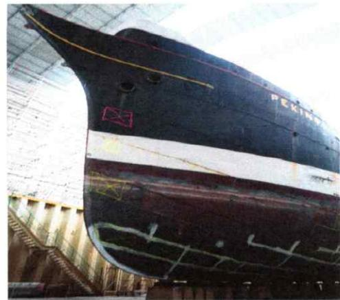
Die Zertifizierungsgesellschaft DNVGL hat jede Stahlplatte des Unterwasserschiffes auf die Stahldicke vermessen und ist zu dem positiven Ergebnis gekommen, dass alle Platten über dem vom DNVGL vorgegebenem Minimumwert liegen ! Das führt zu dem sehr erfreulichen Ergebnis, dass das Original-Unterwasserschiff erhalten bleibt und dieses nicht durch einen Neubau ersetzt werden muss. Es werden nur noch die Stahlplatten in der Außenhaut ersetzt, die nicht mehr restauriert werden können.
