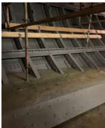
Die Schweißplatten dienen dazu, um die Ladung vor dem an der Bordwand herunter laufendem Schwitzwasser zu schützen
